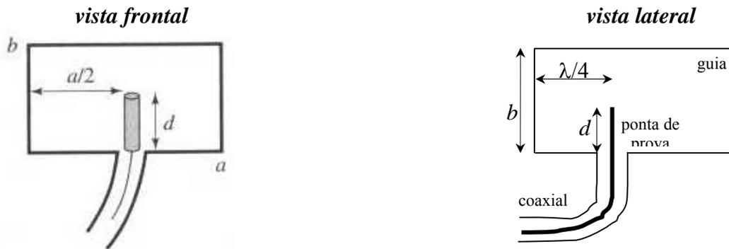
O comprimento da sonda ( $d$ ) deve ser escolhido de forma a obter casamento de impedância entre o cabo coaxial e o guia de onda. Além disso, a sonda deve estar a uma distância de  $\lambda/4$  da terminação curto-circuitada do guia de modo que as ondas que se refletem na terminação estejam em fase com as ondas que são radiadas diretamente pela sonda dentro do guia.
